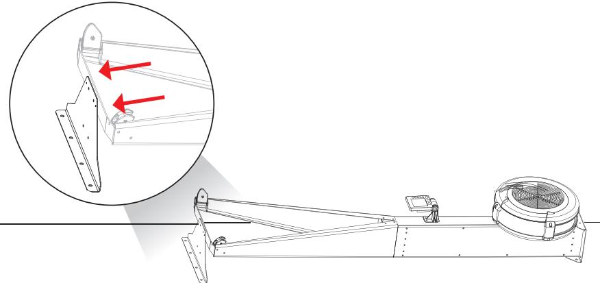
**FI** Aseta SkiErg makuulle lattialle vauhtipyörä ylöspäin, kiinnitä tukilevy SkiErgon yläkiinnikkeeseen kahdella ruuvilla SkiErgon yläkiinnikkeeseen.
