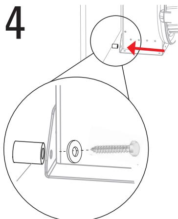
**DE** Setzen Sie ein schwarzes Distanzstück hinter jedem Montageloch an der unteren Halterung. Setzen Sie je eine Unterlegscheibe auf die Schrauben und schrauben Sie die untere SkiErg Halterung fest an.
